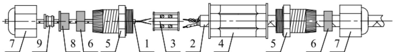
1 – НЧЭ; 2 – ЧЭБ; 3 – колодка коммутационная винтовая; 4 – втулка полая соединителя; 5 – футюра с цанговым зажимом; 6 – уплотнитель резиновый кольцевой; 7 – гайка; 8 – уплотнитель резиновый т-образный; 9 – уплотнитель кабеля ФРСБ.713671.001-01 (из комплекта поставки)
